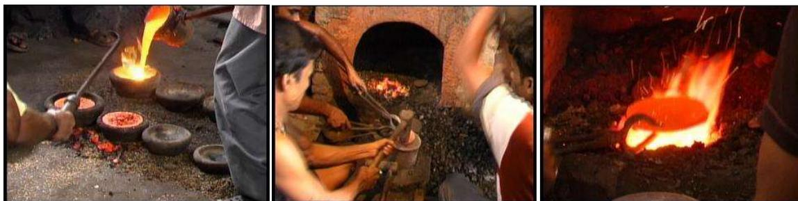
Les premières courbes apparaissent. Une personne est chargée de maintenir la plaque chauffée au rouge pour qu'elle puisse être forgée. Pour obtenir la forme finale un bol d'environ un kilo doit être chauffé au rouge une centaine de fois.
